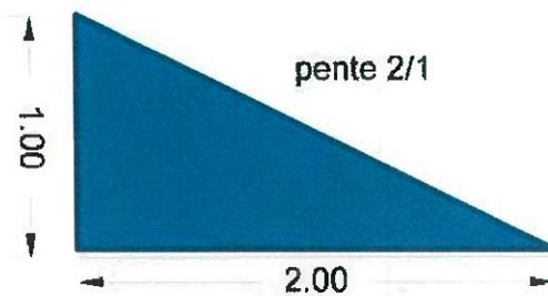
Figure 7 : Présentation des pentes de talus utilisé pour le projet
