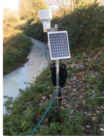
Figure 6: Appareil de MHF installé sur la Peene becque à Steenvoorde
