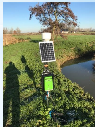
Figure 6: Appareil de MHF installé sur l'Yser à Wormhout
