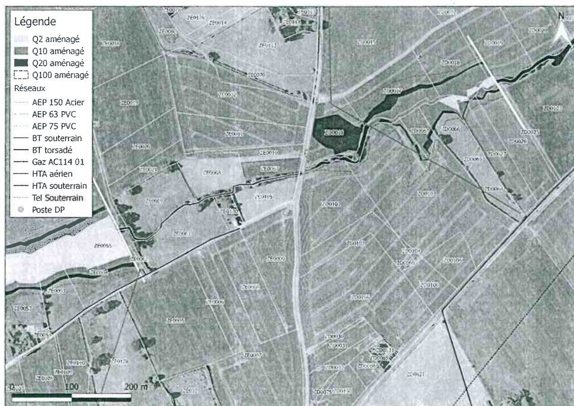
Fig. 4. Localisation des différents réseaux concessionnaires
